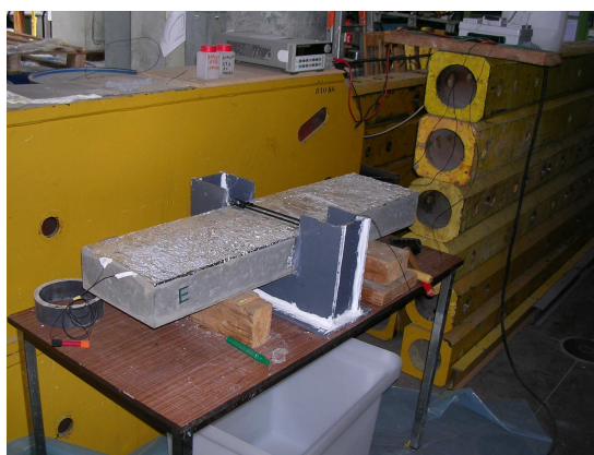
FIGURE 1 – Corrosion des armatures sur une longueur contrôlée de 10 cm
