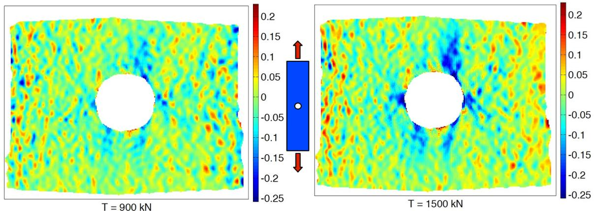
FIG 1 -Détection de l'endommagement progressif pour un essai de traction sur plaque percée d'un trou par l'analyse des écarts entre déformations transverses numériques et expérimentales [15].
