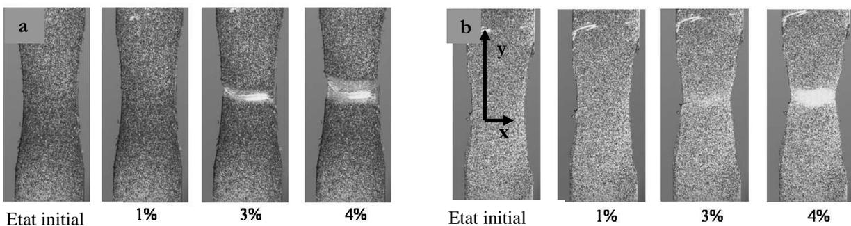
FIG. 1 – Séquences d'images acquises pour un PET recyclé (a) et vierge (b)
