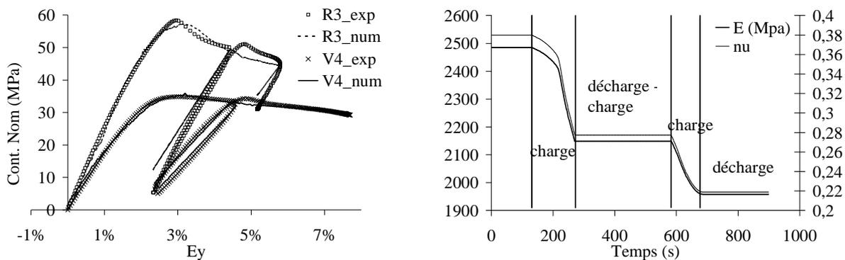
FIG. 4 – a) Identification de comportements macro-homogènes pour 2 types de formulations b) Evolution des caractéristiques mécaniques au cours du temps (Cas du PETR2)
