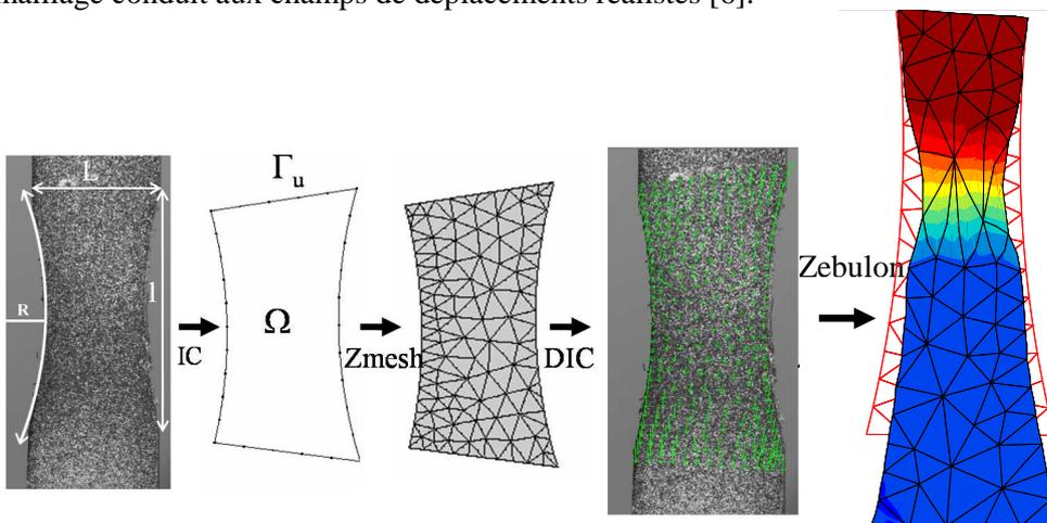
FIG. 5 – Corrélation d’images et calcul de structure
