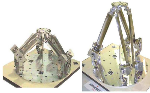
FIG. 2 – Hexapode à rubans métalliques
