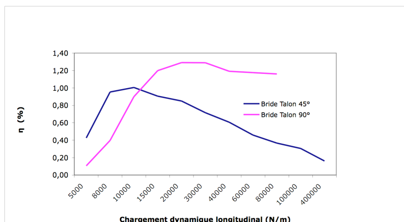
FIG. 6 - Evolution du facteur de perte de la bride sous un chargement dynamique longitudinal, chargement statique en compression 50 kN/m, précharge des boulons égale à 400 MPa.
