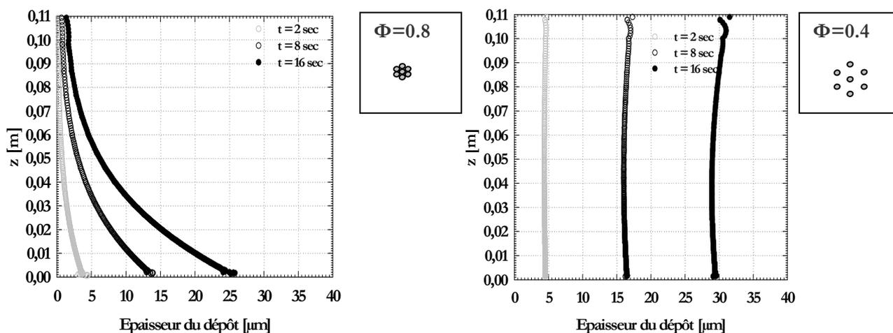
FIG. 4 – Croissance du dépôt de filtration en fonction du temps pour une compacité élevée  $\Phi=0.8$  et une compacité plus faible  $\Phi=0.4$  ( $\Delta P=0.8$  bar  $c=8$  g.l<sup>-1</sup>).
