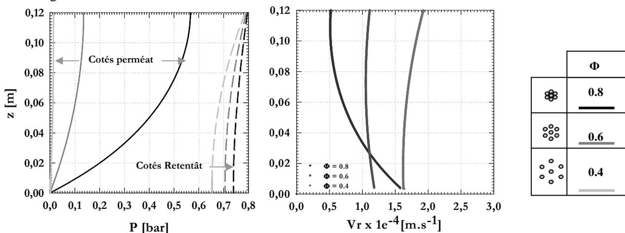
FIG. 2 – a) Variation de la vitesse de liquide et b) de la pression le long de l'axe z pour une filtration à l'eau pure pour 3 compacités différentes;
