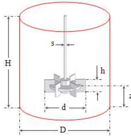
FIG. 1 – Paramètres géométriques du système d'agitation mécanique
