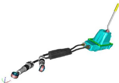
FIG. 1 – Commande externe par câbles
