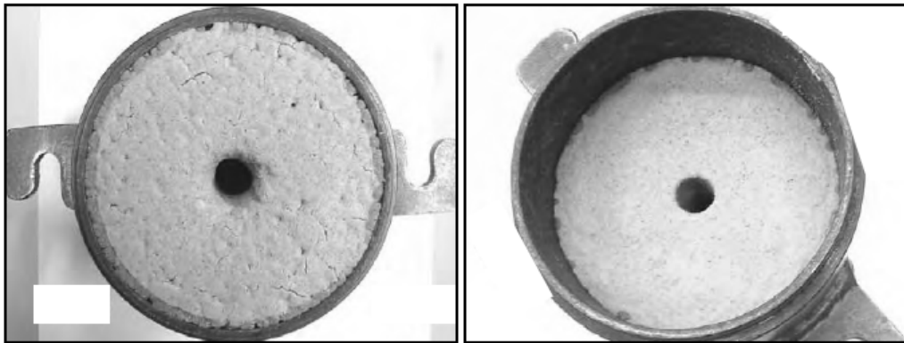
FIG. 2 - Faces avant et arrière de l'échantillon avant essai
