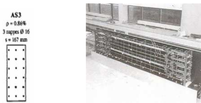
FIG. 1 – Répartition des aciers dans le tirant
