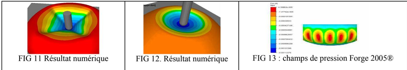
En absence de pression (Fig. 12), on remarque l'affaissement de la membrane sous l'effet de l'impacteur sans apparition de plis (expérimentalement et numériquement).
