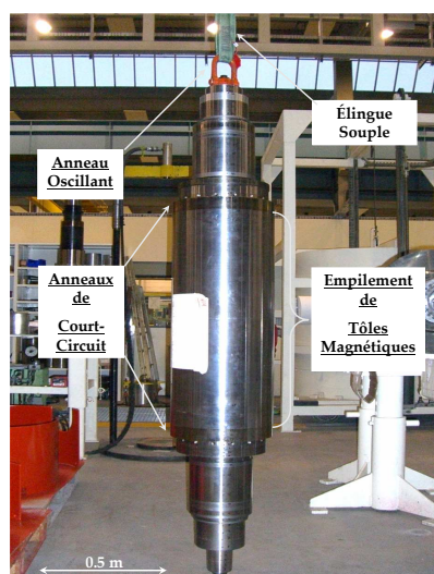
(a) Dispositif de suspension du rotor.
