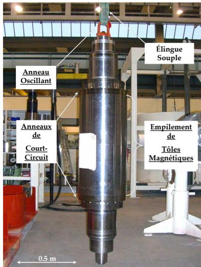
(a) Dispositif de suspension du rotor.
