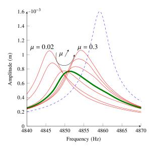
FIGURE 4: FREQUENCY FORCED RESPONSES FOR THE 1T MODE. (--): LINEAR (STUCK) CASE; (--): OPTIMAL CASE  $\mu_{1T}^* = 0.1.$  (--): OTHERS VALUES OF  $\mu$  (0.02, 0.03, 0.07, 0.15, 0.2, AND 0.3 IN THIS ORDER).
