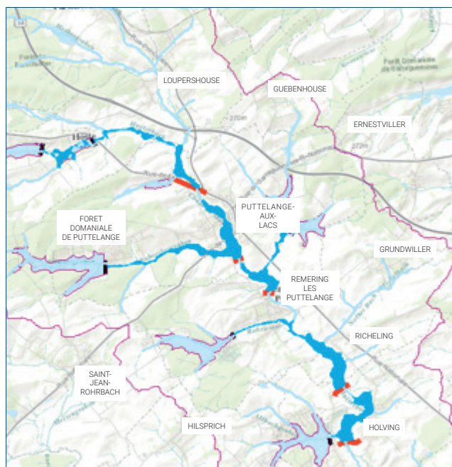
Simulation de l'inondation défensive à l'aide du logiciel HEC-RAS (openstreetmap). Conception : Sleimane Hariri, Isabelle Charpentier. Réalisation : Sleimane Hariri
