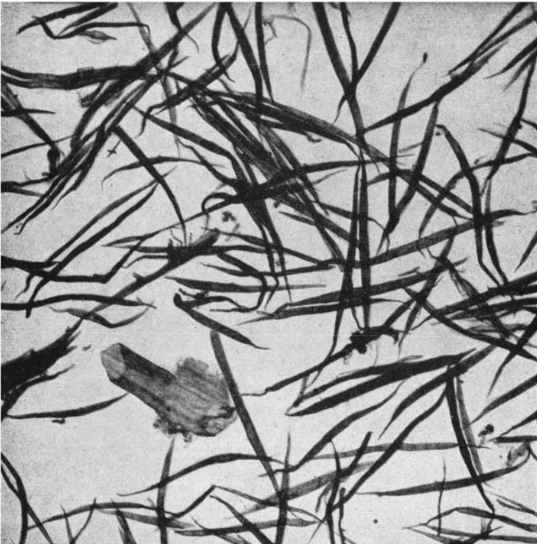
Pterocarya caucasica — Etude de la pâte de bois. Microphotographie: G = 50 X, Réf. D 565 d 671.
