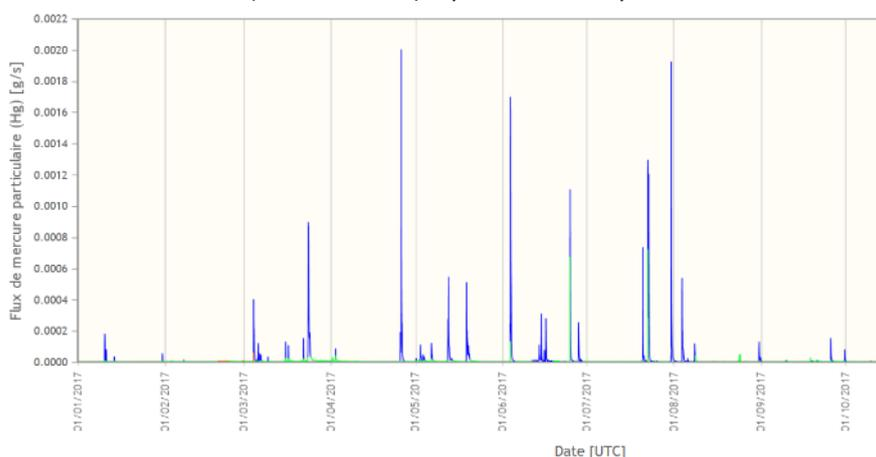
La mesure du débit, de la concentration en MES et des concentrations en contaminants associés aux particules permettent le calcul de flux horaires de MES et de contaminants sur le Gier à Givors.
