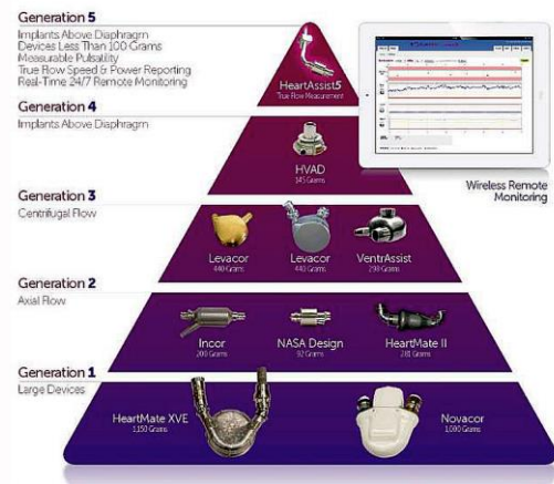
Fig. 5. Les différentes générations de pompes d'assistance circulatoire [4].
