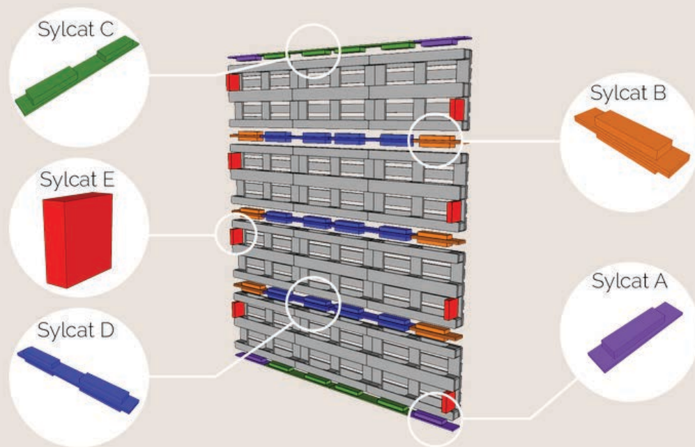
Figure 1. Vue éclatée des pièces Sylcat® pour l'assemblage de murs en palettes. © Sofrinnov.
