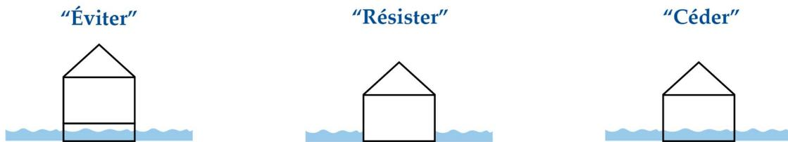
Figure 2 : À l'échelle de l'édifice, différents principes pour s'adapter aux submersions et aux inondations. Source : Centre Européen de Prévention du Risque d'Inondation (Cepri).
