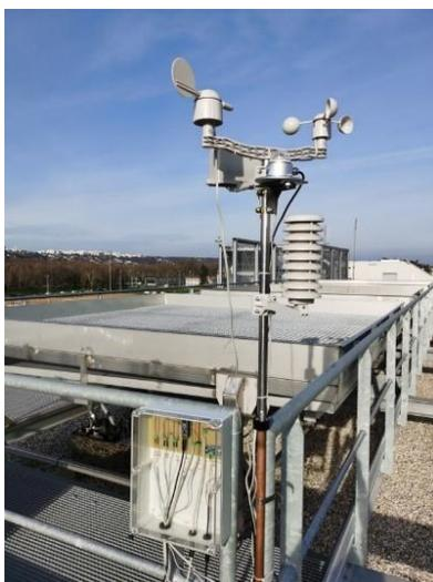
Figure 1. Station météorologique à bas coût installée sur la plateforme expérimentale GROOF avec (de gauche à droite et de haut en bas) : anémoscope, anémomètre, pluviomètre (à l'arrière), pyranomètre, et capteur de température, d'humidité et de pression de l'air.
