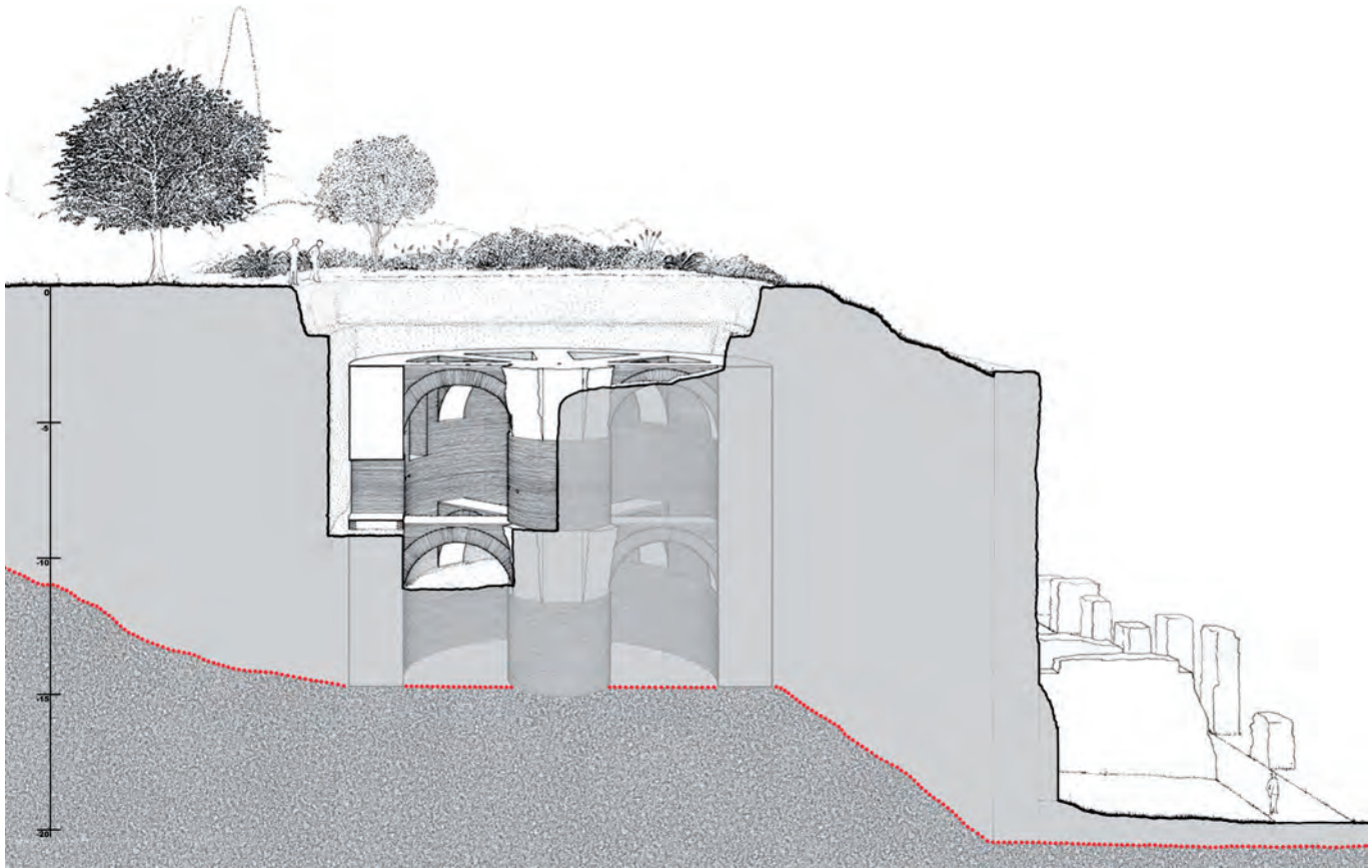
11 – SEZIONE PROSPETTICA RICOSTRUTTIVA DELL'EDIFICIO NERONIANO RINVENUTO NELL'AREA DELLA VIGNA BARBERINI È visibile il piano di campagna contemporaneo, ricoperto alla fine del I secolo dalle terre impiegate per creare la terrazza sulla quale fu poi eretta una parte del palazzo flavio.
