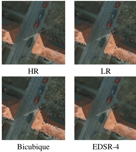
FIGURE 2 – Illustration des résultats fournis par l’EDSR : image haute résolution (HR) à 12,5cm/pixel et sa version artificiellement réduite (LR) à 50cm/pixel (agrandie pour une meilleure lisibilité), résultats fournis à 12,5cm/pixel par l’interpolation bicubique et par la super-résolution EDSR (facteur 4).
