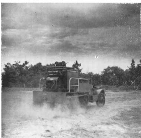
Half-Track équipé en moto-pompe.
