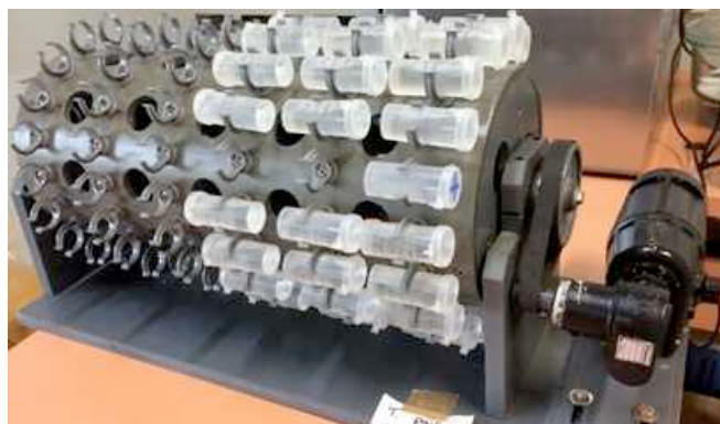
Figure 65 : Rotagit, système permettant l'homogénéisation de la contamination du biofilm développé sur lames de verre (rotation lente à raison de 5 tours par minute)
