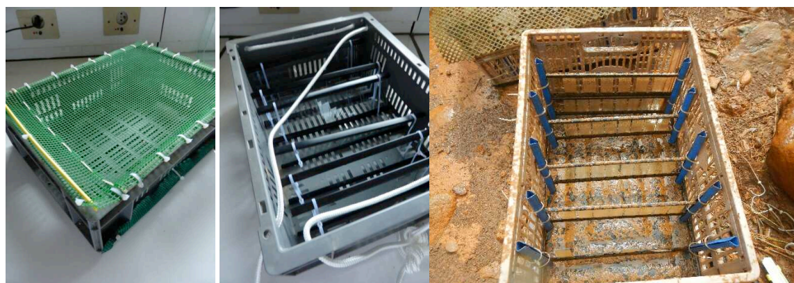
Figure 63 : Cages perforées contenant 54 lames de microscope vierges pour colonisation du biofilm en milieu naturel, puis après 3 semaines de colonisation sur le terrain
