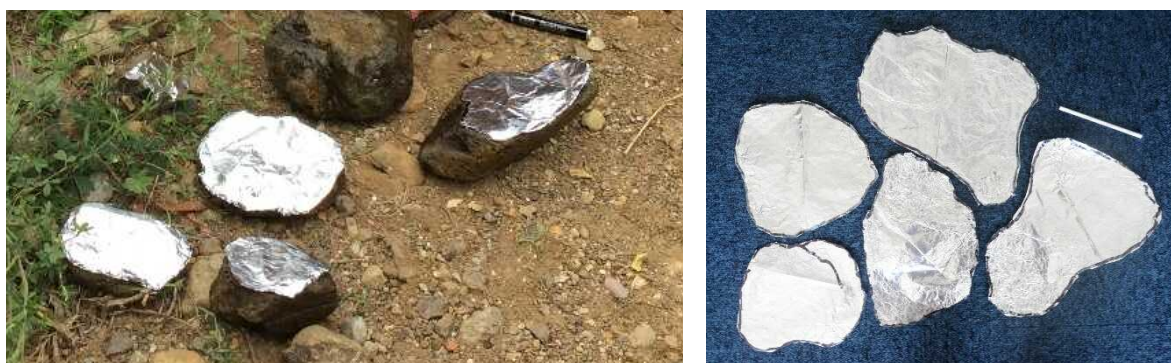
Figure 27 : Moulage des substrats naturels (galets) échantillonnés et photos des surfaces moulées avant mesure par le logiciel Mesurim
