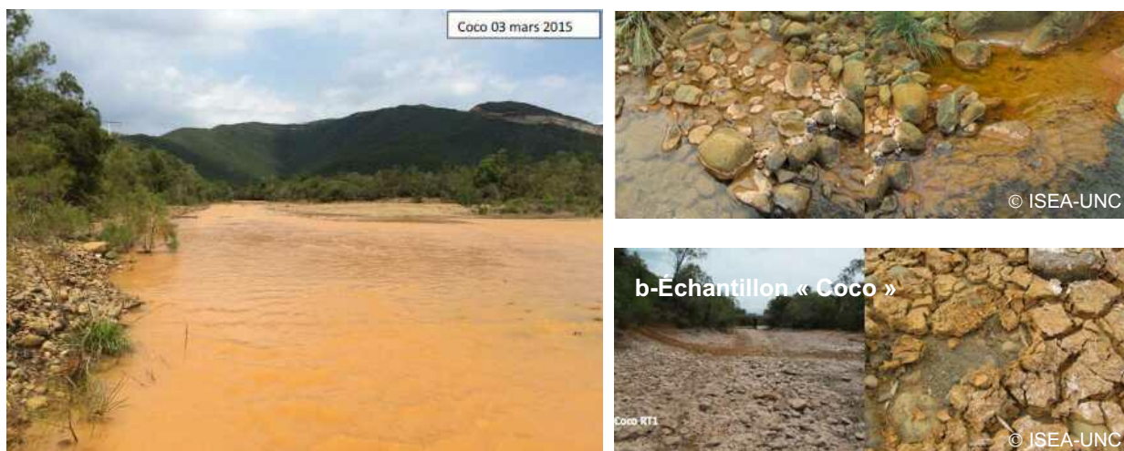
Figure 36 : Photographie de la rivière Coco suite à l'épisode pluvieux et au débordement du bassin de sédimentation en mars 2015 (gauche), photographies des sédiments latéritiques déposés après la fuite du décanteur en mars 2015 et collectés en novembre 2015 a- au niveau de la Taléa, bras gauche, et b- dans le lit de la Coco sous forme de la croûte de dessèchement (gauche).
