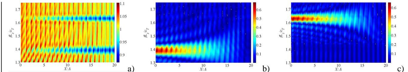
FIG. 4 – Module de l'amplitude normalisée de modes en fonction de la coordonnée spatiale adimensionnée  $x/\Lambda$  et de la fréquence adimensionnée  $fL/c_T$  : a) mode incident SH0, b) mode diffusé SH2, et c) mode diffusé SH3.
