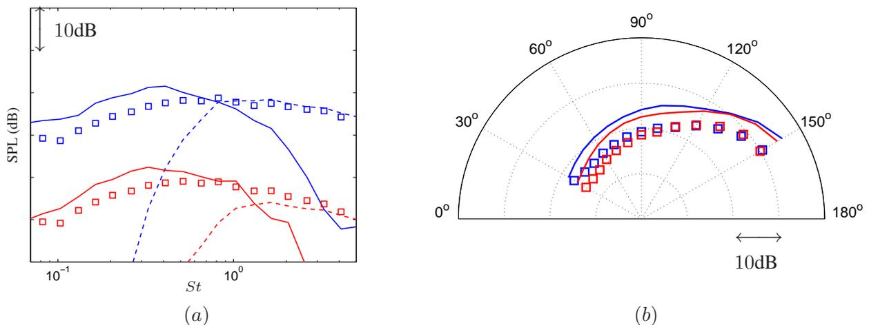
FIGURE 4 – Niveaux acoustiques à  $r = 30D$  pour les deux SGE (jet1 et jet2). (a) Spectres acoustiques en tiers d'octave pour  $\theta = 120^\circ$ . □ mesures, —  $SPL_{BF}$ , - - -  $SPL_{HF}$ . Les niveaux du jet2 sont représentés avec décalage vertical de  $-20dB$ . (b) Niveaux acoustiques intégrés en fréquences (OASPL). □ mesures, — méthode hybride.
