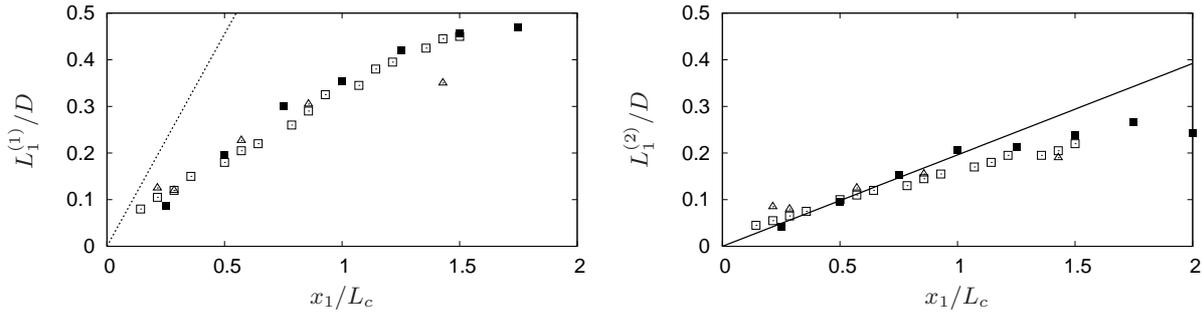
FIGURE 3 – Evolution axiale des échelles intégrales  $L_1^{(1)}/D$  et  $L_1^{(2)}/D$  dans la couche de mélange ( $x_2 = 0.5D$ ) pour le jet1. ■ SGE, □ Fleury [16], △ Pokora [18], ··· Davies *et al.*[19] ( $L_1^{(1)} = 0.13x_1$ ), — Liepmann *et al.*[20] ( $L_1^{(2)} = 0.028x_1$ )
