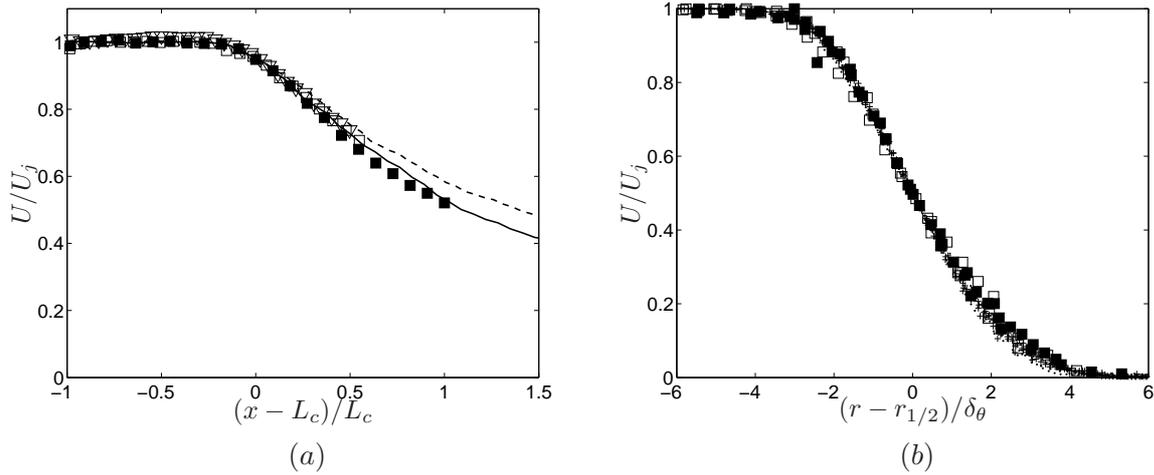
FIGURE 1 – Profils adimensionnés de vitesse axiale. (a) Evolution sur l’axe en fonction de la distance adimensionnée  $(x - L_c)/L_c$ . SGE : - - - jet1, — jet2, PIV[16] :  $\nabla$  jet1, LDV[17] :  $\square$  jet1,  $\blacksquare$  jet2. (b) Profils radiaux. Entre  $x/D = 1$  et 4 pour le calcul ( $\cdot$  jet1,  $+$  jet2) et en  $x/D = 1, 2.5$  et 5 pour les mesures LDV ( $\square$  jet1,  $\blacksquare$  jet2)
