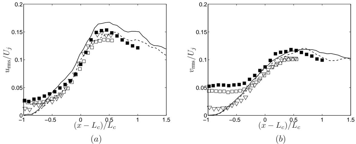
FIGURE 2 – Profils adimensionnés des tensions de Reynolds  $u_{\text{rms}}$  (a) et  $v_{\text{rms}}$  (b). Evolution sur l’axe en fonction de la distance adimensionnée  $(x - L_c)/L_c$ . SGE : - - - jet1, — jet2, PIV[16] :  $\nabla$  jet1, LDV[17] :  $\square$  jet1,  $\blacksquare$  jet2.
