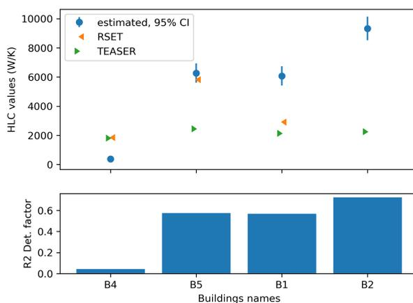
FIGURE 3. Comparaison des coefficients de déperditions calculés
