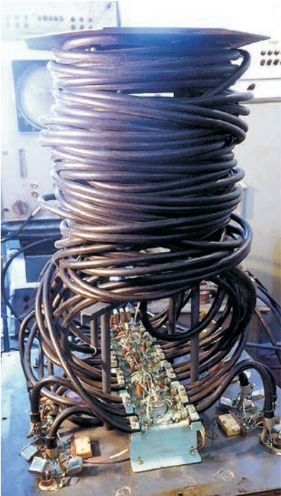
Рис. 17. Один з фазообертачів типу ФВ 6-4 (корпус знятий)
