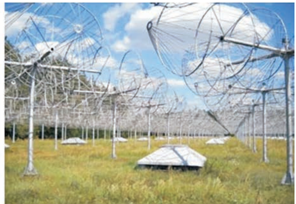
Рис. 18. Найбільший фазообертач системи фазування радіотелескопа УТР-2 типу ФВ 8-11
