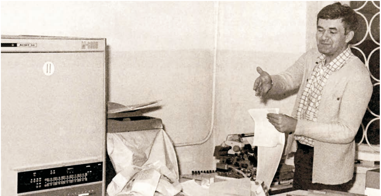
Рис. 37. Обчислювально-керуючий комплекс АСВТ М-6000 (використовувався з початку 70-х років до середини 90-х як перша головна комп'ютерна система для управління телескопом, цифрової реєстрації сигналів і обробки даних)
