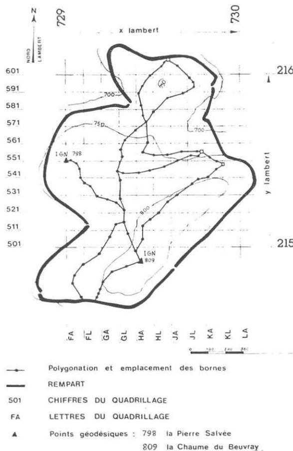
FIG. 1. — Polygonation et quadrillage topographique du site.
