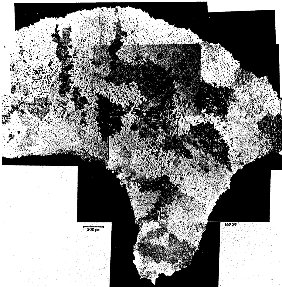
Fig.34 - Section longitudinale d'un fabricat de type 3 : structure dendritique
