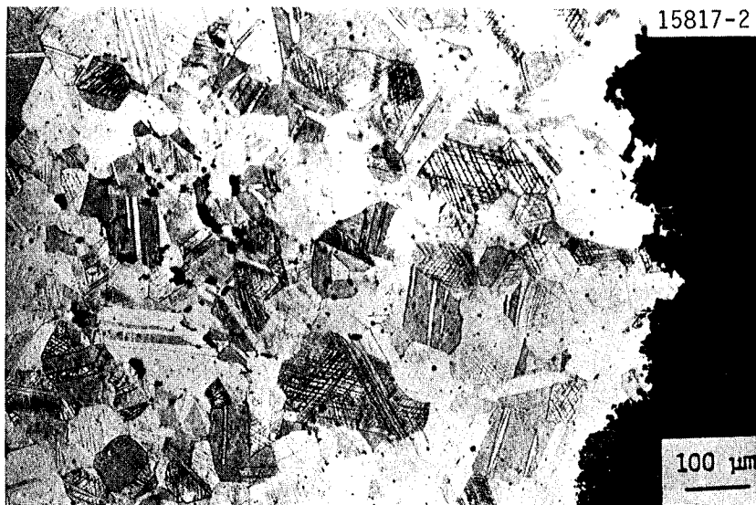
Fig.25 - Microstructure de la section transversale de la corde ; structure faiblement écrouie
