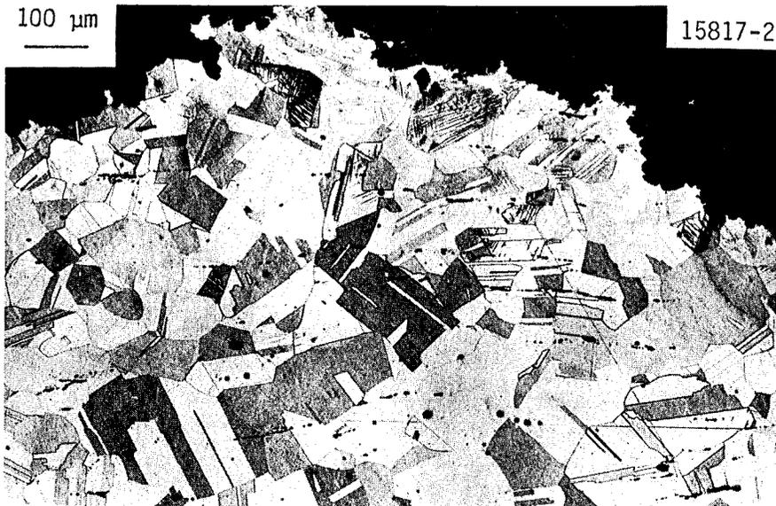
Fig.24 - Microstructure typique de l'arc ; structure recristallisée
