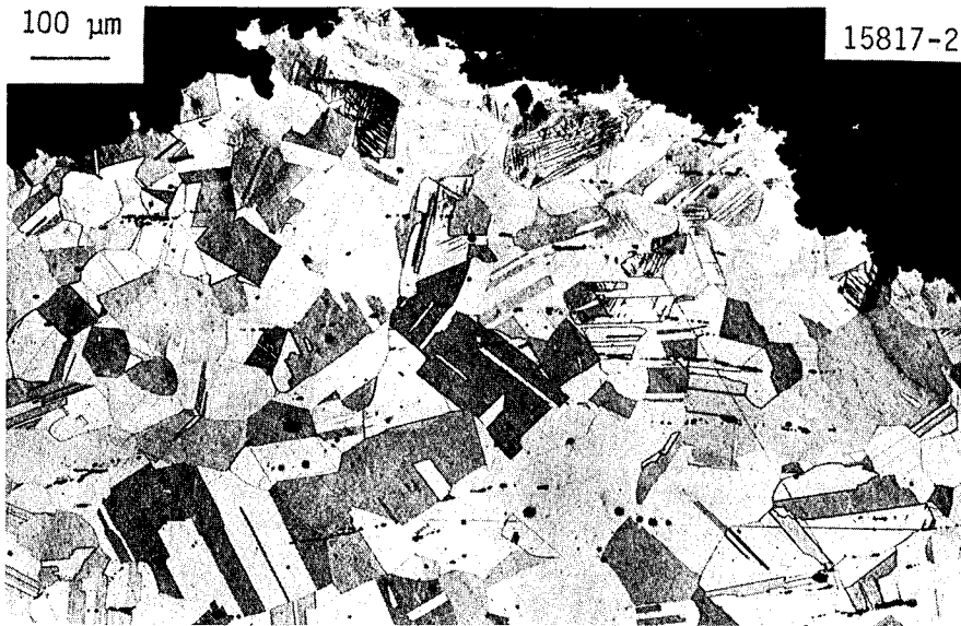
Fig.24 - Microstructure typique de l'arc ; structure recristallisée
