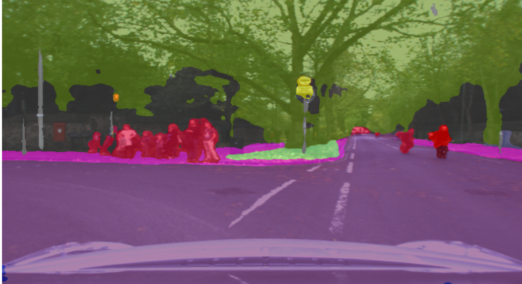
Segmentation d'une image de jours par le réseau DeepLabV3+. Database de RobotCar[4]
