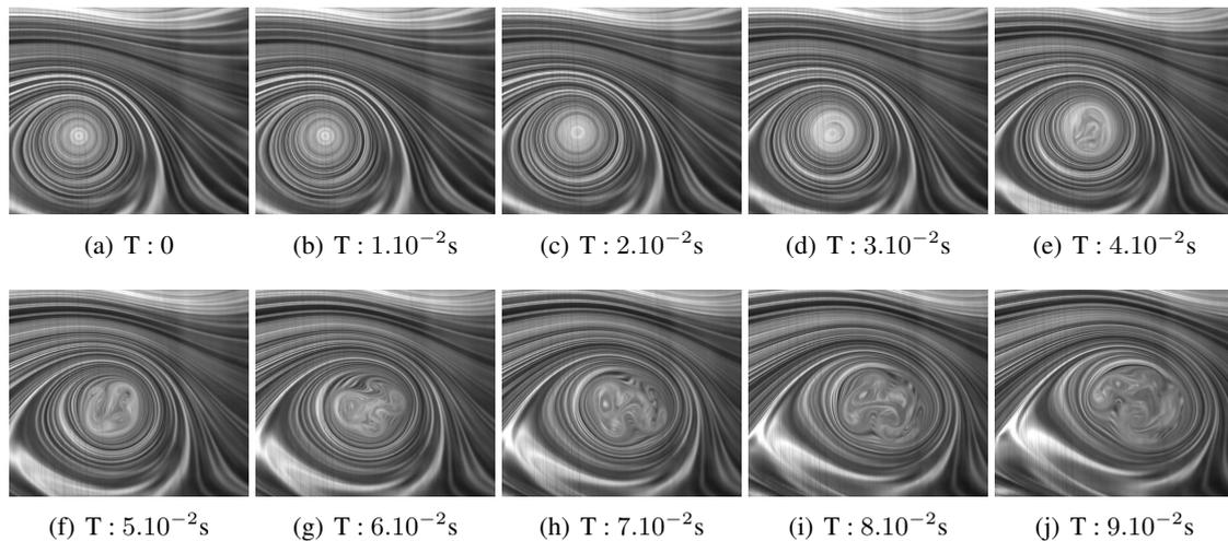
FIG. 3 – Visualisations de la déstabilisation (vue de côté)
