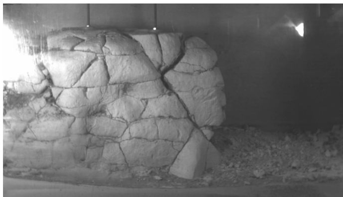
FIG. 2 – Bloc de craie "sous miné" avant la rupture complète de l'échantillon (d'après Stone et al , 2002)
