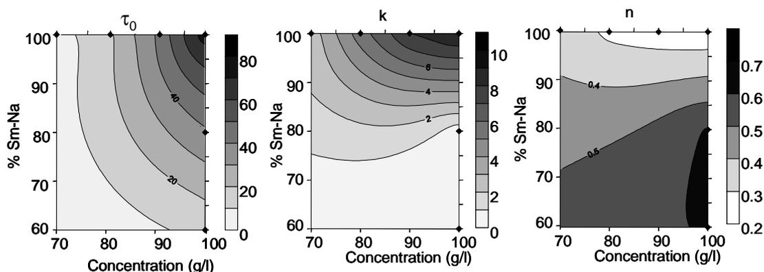
FIG 3 : Evolution des paramètres de la loi d'Herschel-Bulkley pour des écoulements établis en fonction de la concentration pour des suspensions de diverses saturations.
