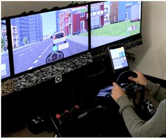
Figure 5 : Aperçu du simulateur de conduite ScannerStudio connecté à la première version de l'interface
