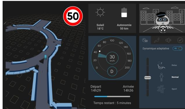
Figure 6 : Aperçu de la nouvelle version de l'interface en cours d'implémentation. Sur le radar : le cube bleu-turquoise représente le VA ; les bandes bleues-claires représentent les trottoirs.
