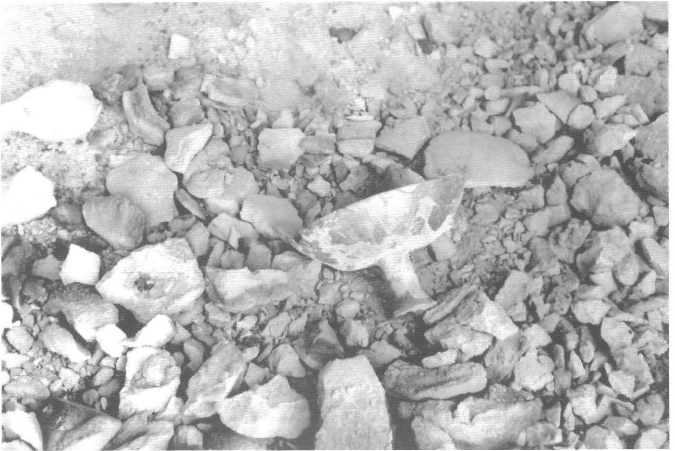
FIG. 24. — Ebauche de vaisselle avec son entonnoir de coulée; le décochage a été effectué à même le sol qui est jonché de fragments de moules.
