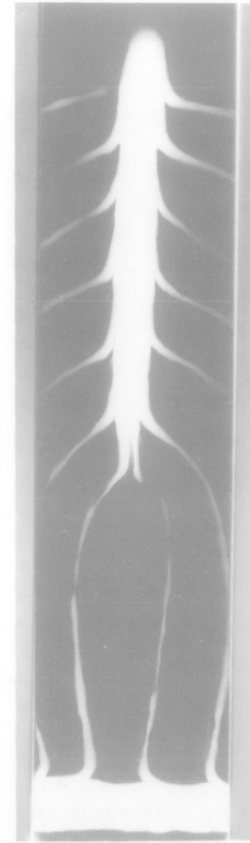
Fig. 1-87 : Fléré-la-Rivière : gril n° 40 : radiographie (Dr G. GAULTIER à Argenton), montrant la séparation des tiges à partir de l'axe central (tirage : R. MALNOURY, Inventaire Centre).
