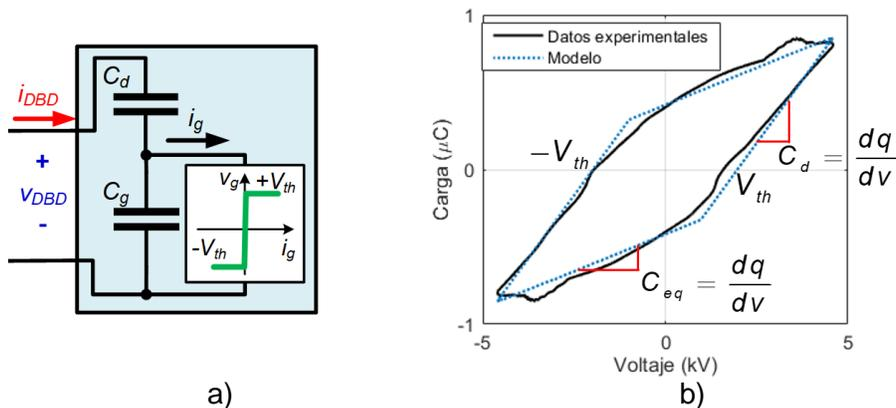
Figura 2. a) Modelo eléctrico simple de la DBD. b) Ejemplo de un diagrama de Manley utilizado para identificación de parámetros.
