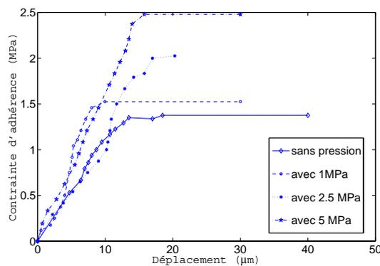
Fig.3 : Relation contrainte d'adhérence-déplacement pour l'éprouvette LMT
