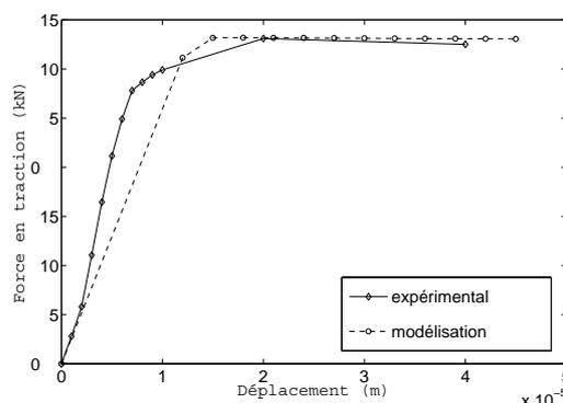
Fig.12 : Relation force en traction-déplacement dans l'essai Pull-out
