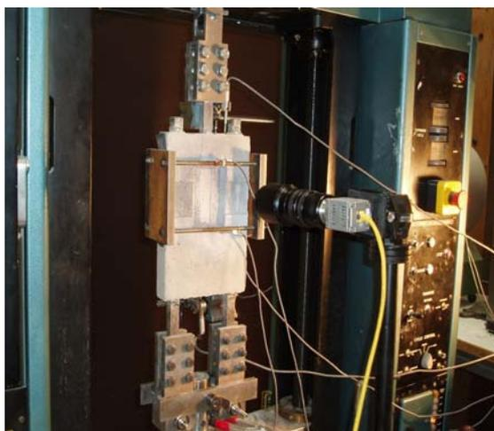
Fig.5 : Mise en place de la caméra
