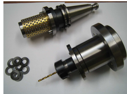
FIG. 1 – La tête de perçage vibratoire auto-entretenue
