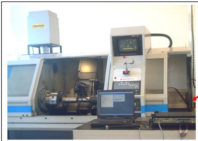
FIG. 1 - Tour et unité d'acquisition.
