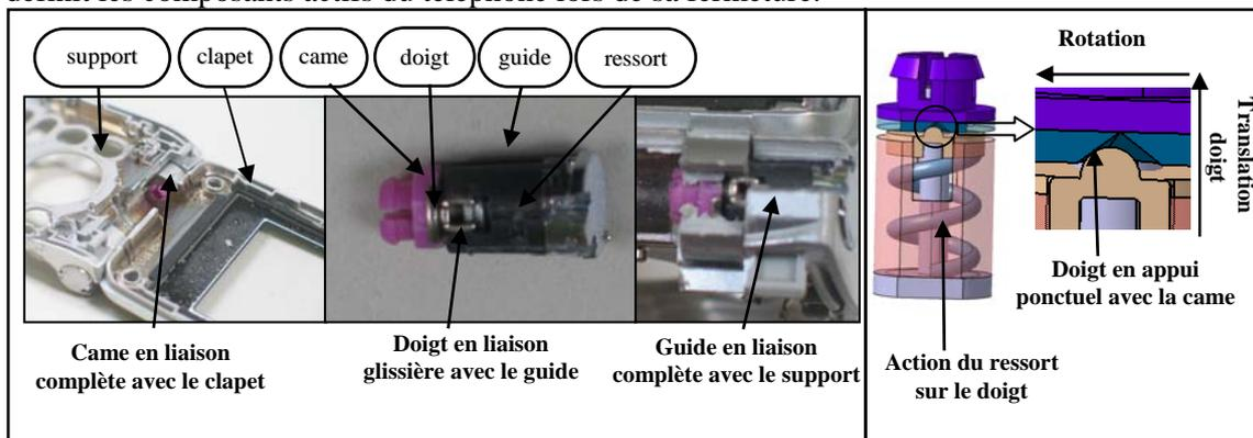
FIG. 2 – Composants impliqués dans la fermeture du téléphone.
