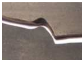
FIG. 6 – Bifurcation de fissure observée sur une éprouvette en CN chargé.
