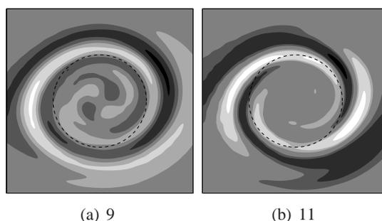
FIG. 3 – Champ de vorticité des perturbations associé à quelques modes de couche critique de la figure 1. Les lignes en pointillés représentent un cercle de rayon  $a$ . Les niveaux des contours sont choisis symétriques autour de la valeur nulle.
