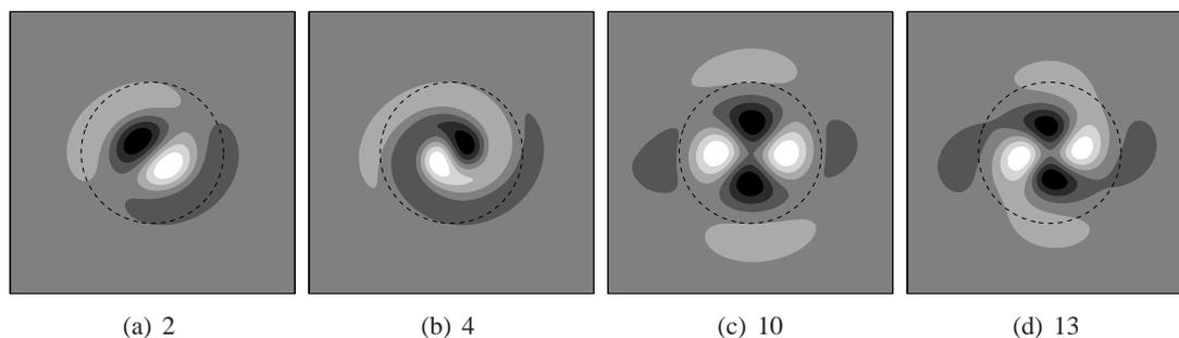
FIG. 2 – Champ de vorticité des perturbations associé à quelques modes de cœur de la figure 1. Les lignes en pointillés représentent un cercle de rayon  $a$ . Les niveaux des contours sont choisis symétriques autour de la valeur nulle.
