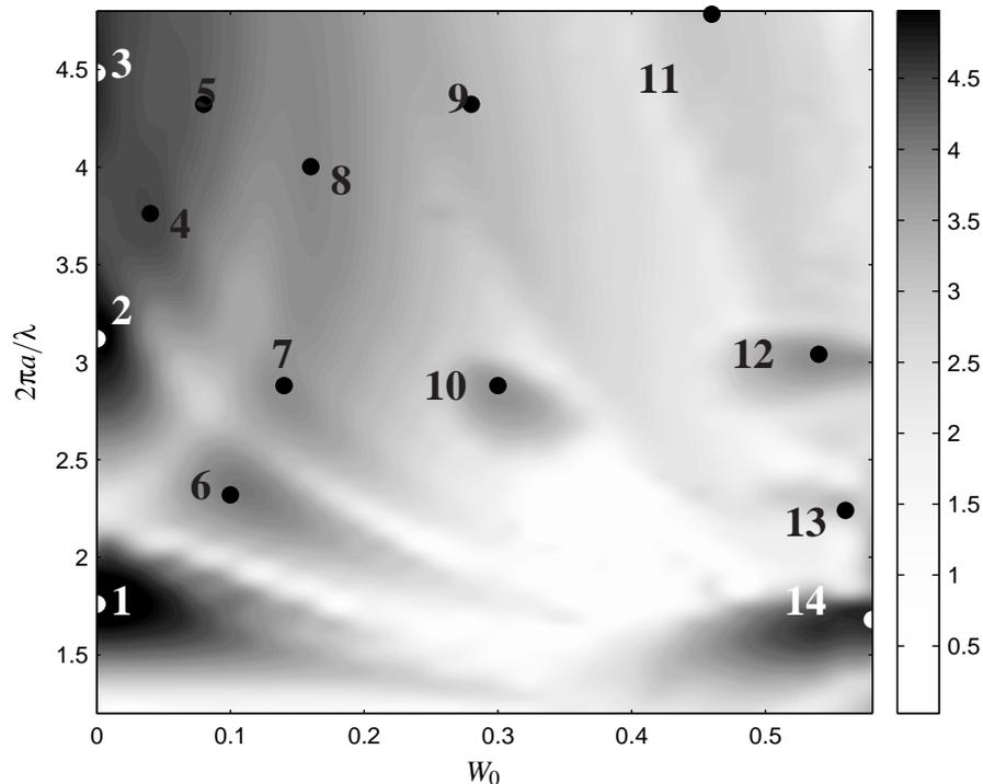
FIG. 1 – Taux de croissance calculé en fonction de  $(W_0, k)$  pour  $Re = 14000$  et  $a/b = 0.18$ . Les zones instables sont classées par  $W_0$  croissant.
