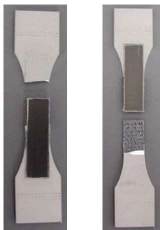
FIG. 4 – Rupture du patch composite.
