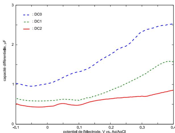
FIG. 2 – Capacité différentielle d’une matrice de microleviers dans une solution de KCl  $10^{-2}$ M, avant (DC0), durant (DC1) et après (DC2) adsorption de décane-thiols. Potentiel de départ : -0.1 V vs. Ag/AgCl.
